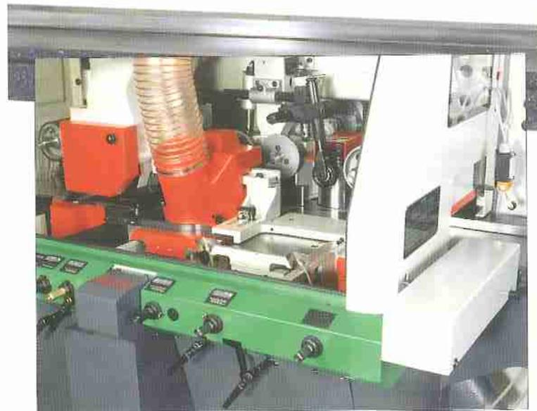
Ein Multitalent ist die linke Mobilspindel. Das unterschiedlich breite Rohmaterial wird elektronisch gemessen und angezeigt. Die Spanabnahme kann programmiert werden. Die Spindel stellt sich automatisch auf die Werkstücke ein. Automatische Spindelverstellung auf Fixmaße.
